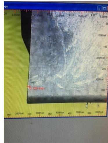
Gambar insert pada saat insert baru digunakan pada menit 7:25 dengan proses pemakanan yang sudah 28mm dilakukan proses pembubutan pada proses pemakanan. Dapat dilihat dari gambar insert masih memiliki nilai Vb 0,120 mm dan belum dinyatakan aus.
