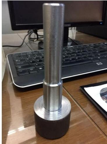
Gambar 1 *Tool Holder* hasil proses permesinan CNC bubut.
