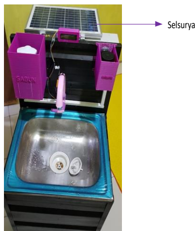
Gambar 3. Tampak atas, Panel surya
