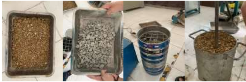
Gambar 6 Pengujian Material Sub Balas
