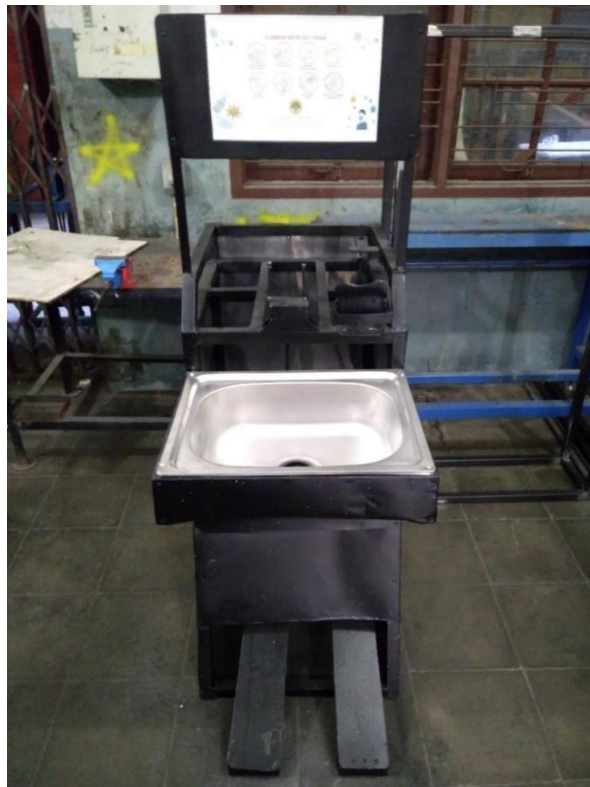
Gambar 2 Hasil perancangan wastafel portable cuci tangan mekanis Gambar 2 ini merupakan hasil desain perancangan wastafel portable cuci tangan
