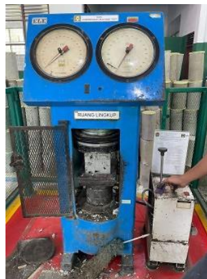
Gambar 6. Pengujian kuat tekan
