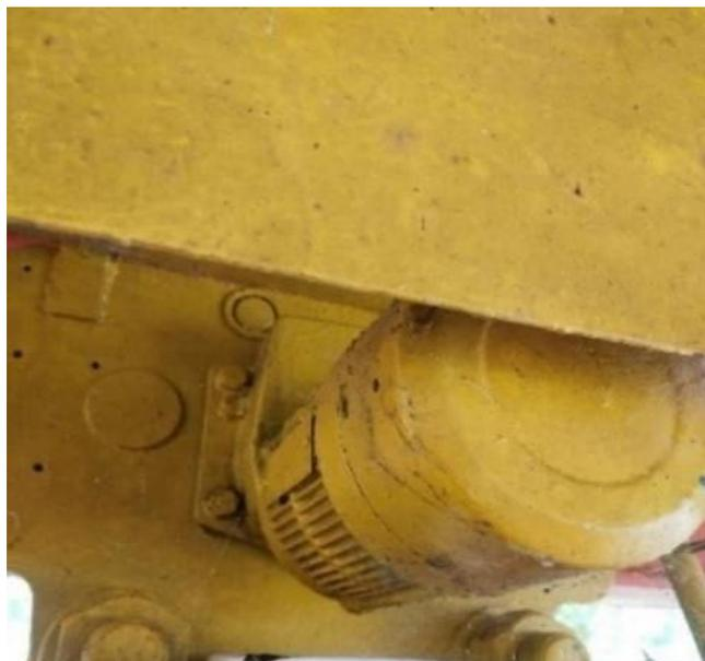
**Gambar 4** Motor pada *crane hoist*
