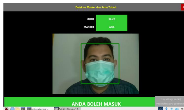
Gambar 12. Pengujian ketika sistem tidak mendeteksi mulut (memakai masker) dan suhu di bawah 38° Celcius
