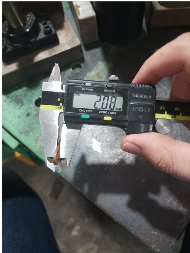
**Gambar 3. Pengukuran Ketinggian Burr**
