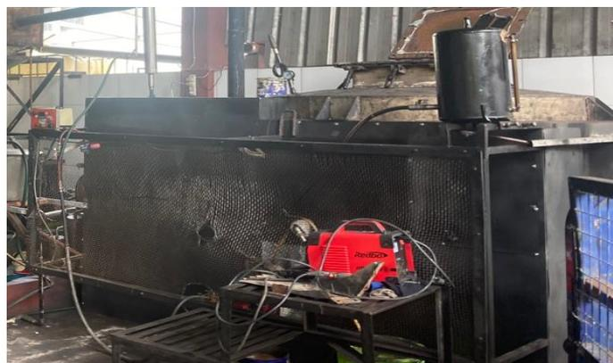
**Gambar 1. Reaktor Pirolisator IPST ASARI**
