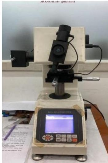
**Gambar 4. Alat uji Kekerasan Vickers**
