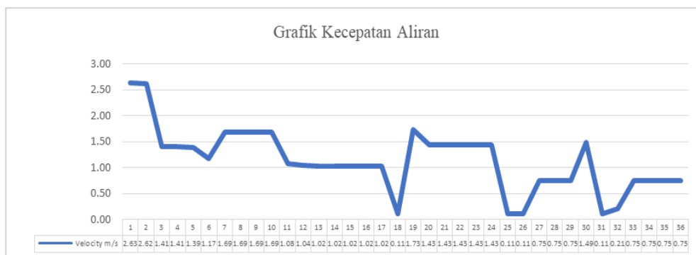
Gambar 6 Grafik Kecepatan Aliran berdasarkan simulasi EPAnet Zona Mundu
