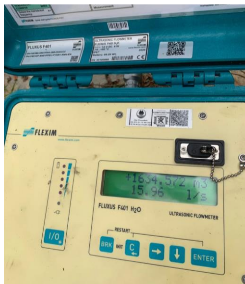
Gambar 1 Ultrasonic Flow Meter untuk Pembacaan Debit Aliran
