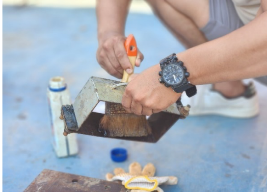
Gambar 2. Melumuri Cetakan Dengan Oli
