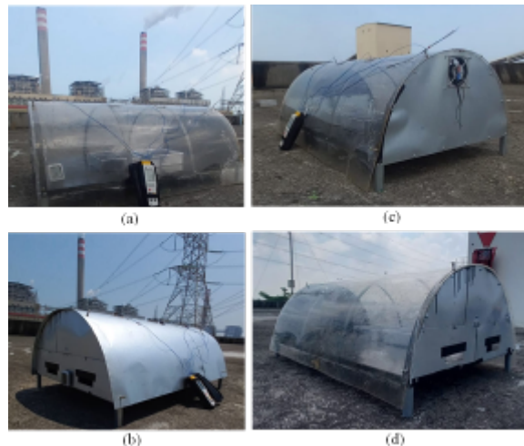
Gambar 3. Prototype greenhouse solar dryer (a) atap akrilik, (b) atap galvalume, (c) tampak belakang, (d) tampak depan
