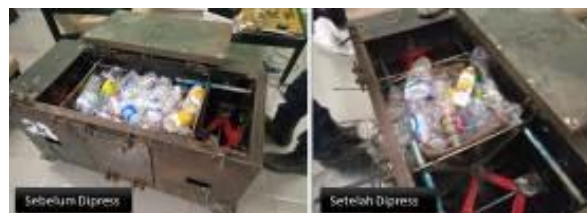
Gambar 9 Posisi Sampah Dalam Ruang Pengepresan
