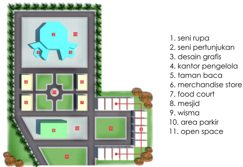
Gambar 4 Massa Bangunan Alt. 1 Sumber : Analisa Penulis, 2013
