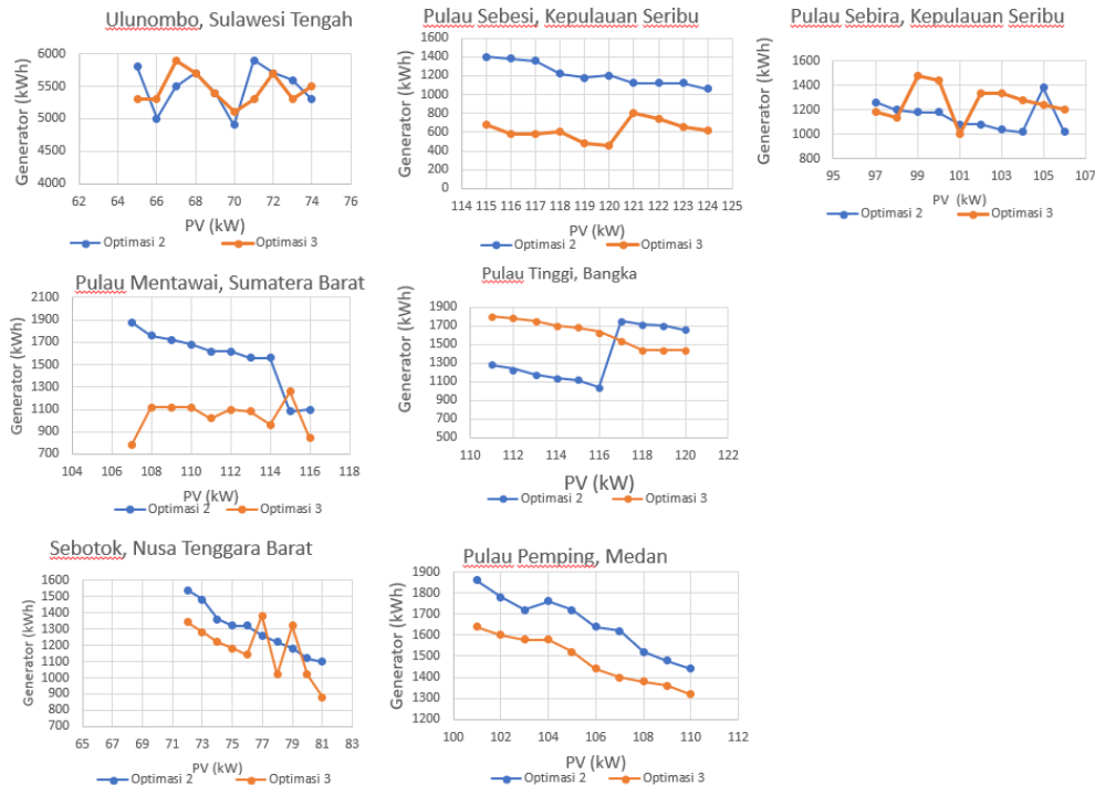
Gambar 5 Grafik Perbandingan Kapasitas PV dan Produksi Energi Generator Diesel Masing-Masing Daerah
