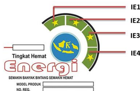
Gambar 7 Pelabelan Motor Induksi Standard IEC
