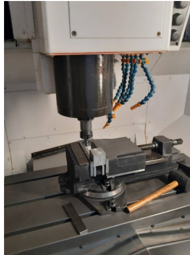
Gambar 5 Proses Milling Pada Specimen
