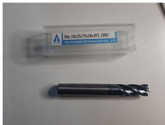
Gambar 2 Cutting Tool Carbide Yang Digunakan
