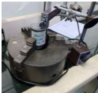
Gambar 3. Proses Pengukuran Menggunakan Surface Roughness Tester
