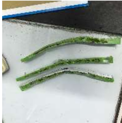
Gambar 23 Hasil Bending 310°C
