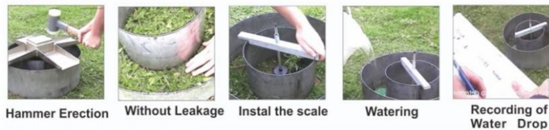
Gambar 1 B : Pemasangan “Double Ring Infiltrometer”
